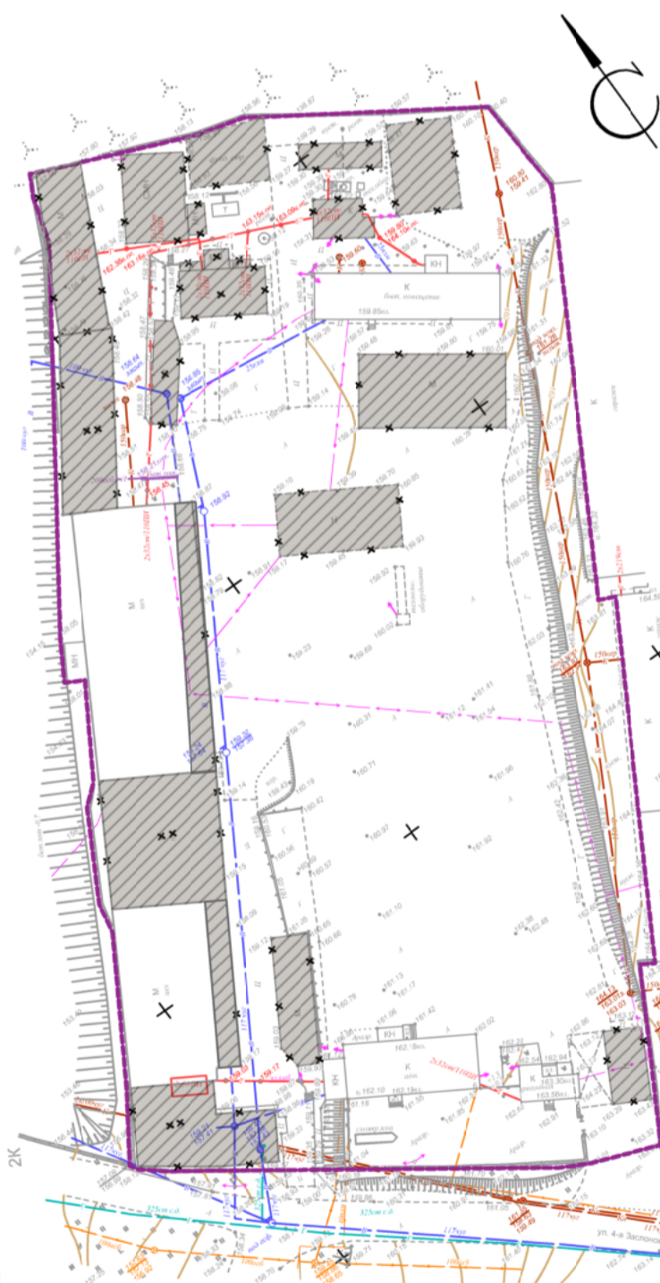
Схема демонтажных работ (снос зданий и сооружений)
